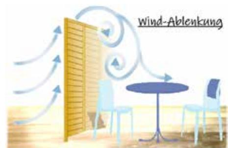
(Abbildung: Windablenkung farbig) Ablenkung: An massiven Wänden prallen Winde ab, verwirbeln und schieben sich häufig in fast gleicher Stärke darüber.
